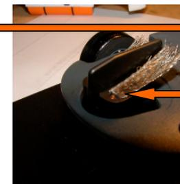
Leitkiel Ninco PRORACE gefedert (ohne Feder verbaut) mit Messer o. ä. kürzen da er sonst an der Karosse streift. Als Schleiferlitze bei dem Wagen silberne Slot.it da ultraflach (der Wagen liegt ohnehin sehr hoch).
